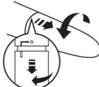
2. Установите алкалиновую (щелочную) батарею типа AAA таким образом, чтобы положительный (+) и отрицательный (-) контакты совпали с полярностью, указанной в отсеке для элемента питания.
